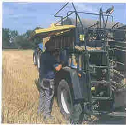
Bis zu 32 Rollen Garn reichen auch für lange Arbeitstage. Die Garnkästen sind ziemlich staubdicht. Der hintere Aufstieg geht nicht beim ersten Ballenkontakt krumm.
