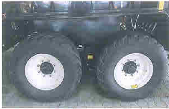
Die nachlaufgelenkte Tandemachse mit Reifen der Größe 560/45 R 22.5 steht für 18 550 Euro in der Preisliste.
