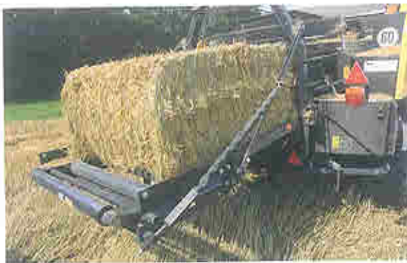
Der letzte Teil der Schurre sitzt mit zwei Wiegezellen auf einem separaten Rahmen. Sobald der Ballen auf dieser Wippe liegt, wird er gewogen. Damit er nicht zu schnell runter rutscht, kann die letzte Rolle gebremst werden.
