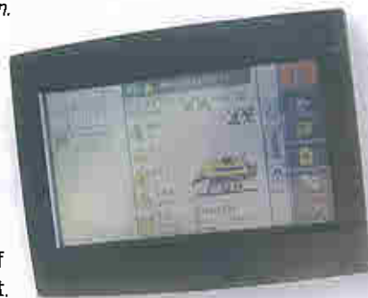
Der farbige „IntelliView III“-Monitor arbeitet mit Touchscreen und ist ISO-tauglich. Hier wird auch das Gewicht des letzten Ballens angezeigt.
