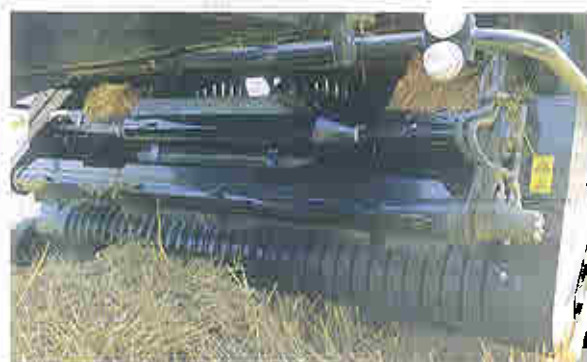
Die zwei hydraulisch angetriebenen Walzen zwischen Pickup und Rotor verbessern den Einzug erheblich und können im „Falle des Falles“ einfach reversiert werden.
